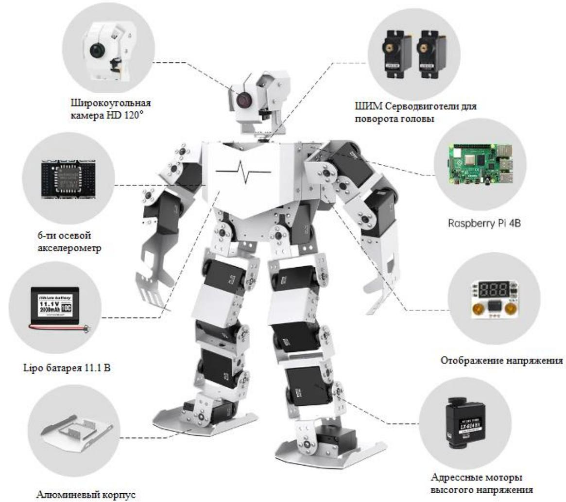
Raspberry Pi 4B — новейший продукт в линейке Raspberry Pi, оснащенный обновленным 64-разрядным четырехъядерным процессором с частотой 1,5 ГГц, встроенным металлическим радиатором, портами USB 3, двухдиапазонной беспроводной локальной сетью 2,4 ГГц и 5 ГГц. более быстрый Gigabit Ethernet и возможность PoE через отдельный PoE HAT. ПРИМЕЧАНИЕ. Эта версия поставляется с 4 ГБ ОЗУ.
